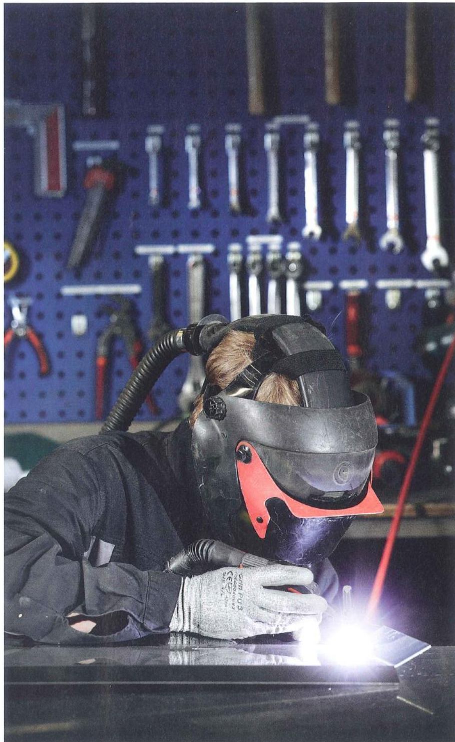
MYÖS KÄSIN. Ohutlevyjä liitetään myös tig-kaarihitsauksella.
