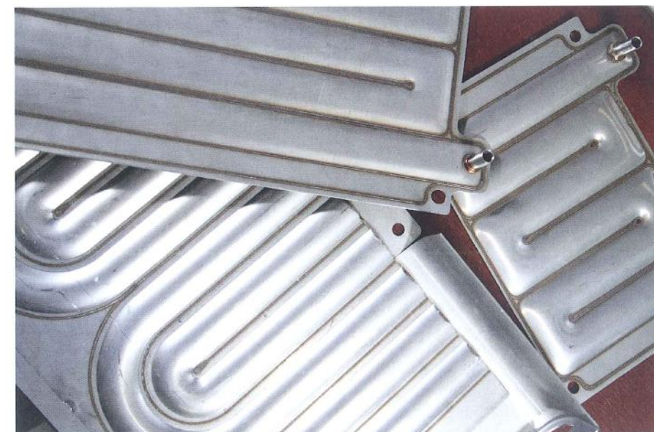
VÄHEMMÄN MATERIAALIA. 4,9 millin paksuiset lämmönvaihtimet valmistuvat hydromuovaamalla. Kokoa vaihtimilla on A4-arkin verran.
